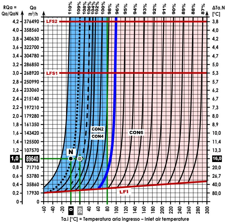
Alcuni Rendimenti  $\eta$  (=  $\eta$  totale @Hi) in vari Punti di progetto (funzionamento) GG-CON (Moduli a Condensazione con modulazione istantanea di fiamma già alla massima portata termica)
