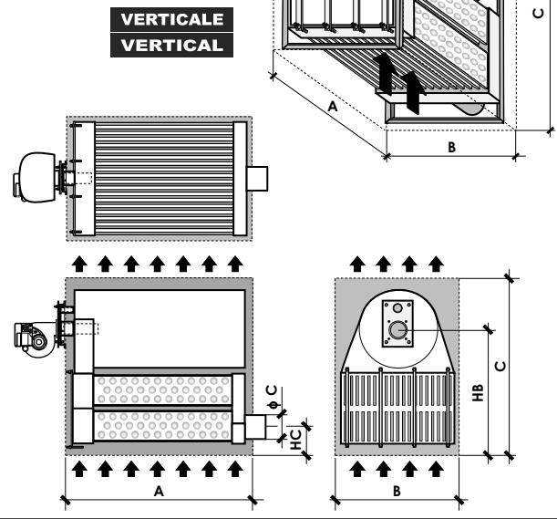
**Area di rispetto AxBxC (grigia):** i pannelli della cassa di copertura (Centrale trattamento aria, Roof-Top, Generatore aria calda, Forno, ecc.) devono essere posizionati esternamente all'area di rispetto.
