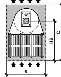
**Area di rispetto AxBxC (grigia):** i pannelli della cassa di copertura (Centrale trattamento aria, Roof-Top, Generatore aria calda, Forno, ecc.) devono essere posizionati esternamente all'area di rispetto.
