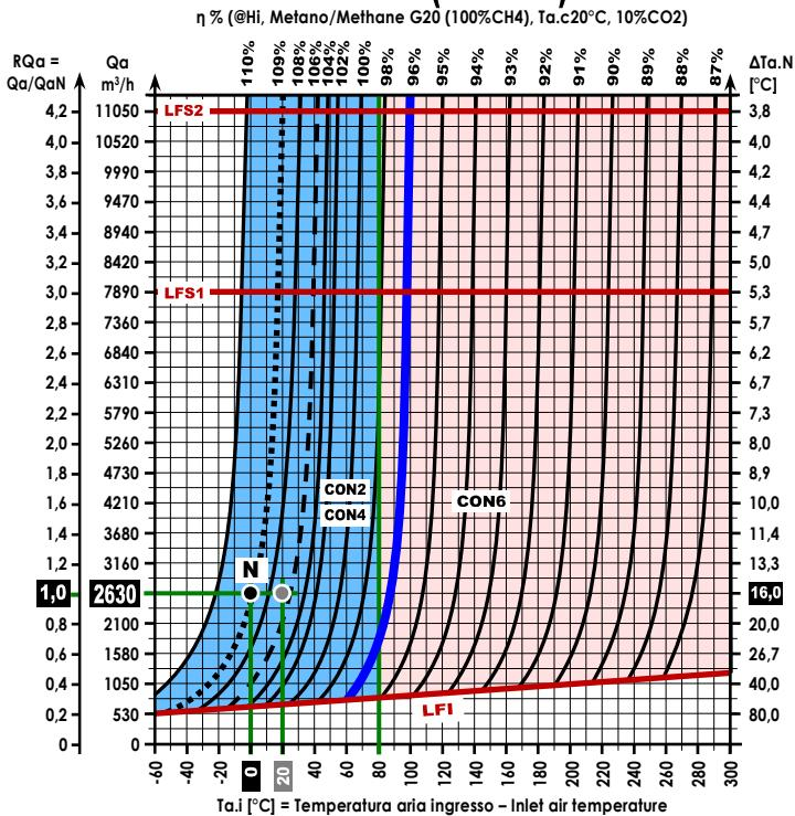
Alcuni Rendimenti  $\eta$  (=  $\eta$  totale @Hi) in vari Punti di progetto (funzionamento) GG-CON (Moduli a Condensazione con modulazione istantanea di fiamma già alla massima portata termica)
