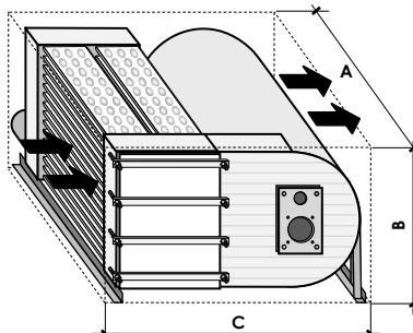
Per le versioni verticali non è necessario specificare il lato bruciatore, poiché l'unità è simmetrica.
